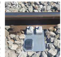
Montierte RFID Tags detektieren Start und Ende der Sprühvorgänge.
